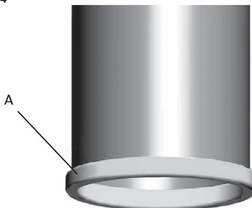
4. Założyć uszczelkę (A) na krawędź rury połączeniowej.
