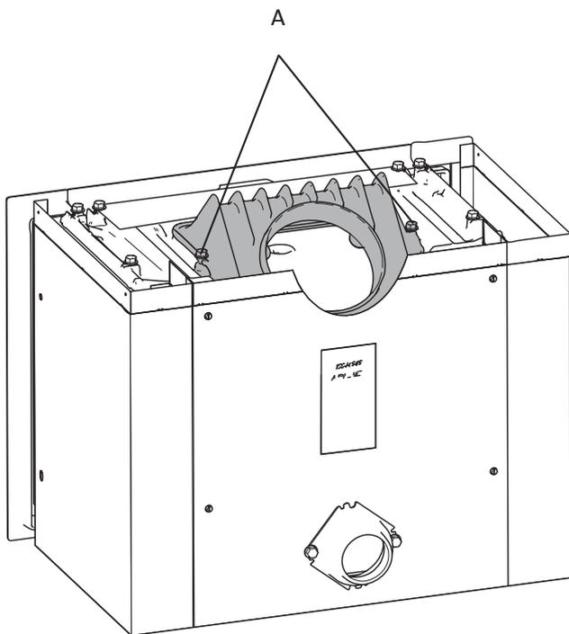
5. Ponownie przykręcić wylot spalin na komorze spalania za pomocą tych samych dwóch wkrętów (A).
