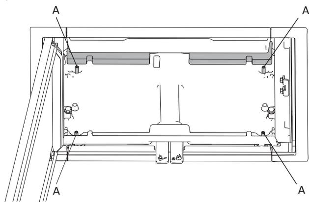
14. Wyregulować śruby poziomujące (A) używając dostarczonego klucza imbusowego, aż komora spalania zostanie wypoziomowana i będzie na odpowiedniej wysokości.
