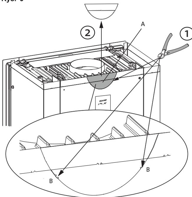
2. W przypadku wylotu tylnego najpierw należy usunąć element zaokrąglony (A). Przeciąć wzdłuż wybijanych otworów (B). Następnie odłamać wybijaną część.
