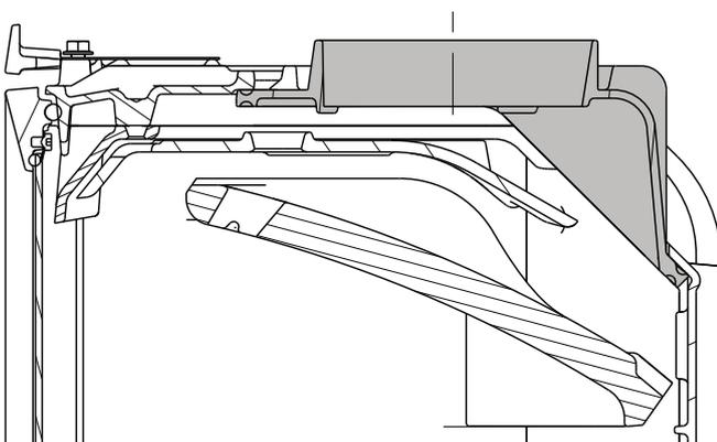
**Wylot spalin zamontowany z tyłu (obrócony o 45°) od zewnątrz**
