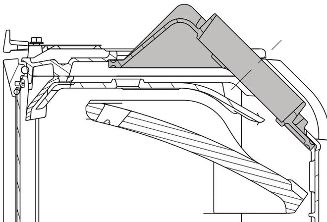
**Wylot spalin górny zainstalowany od wewnątrz**
