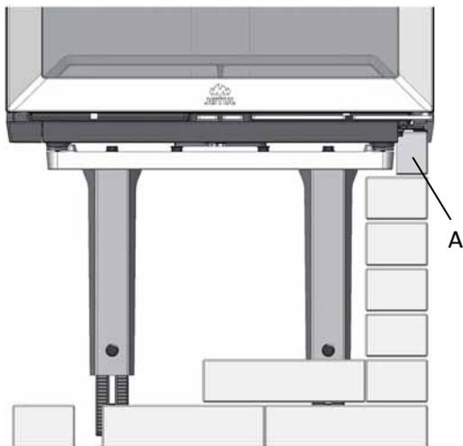
2. Viimeinen tiili (A) leikataan niin, että se sopii jalustan ja rungon väliin. **Huom.!** Muista ottaa huomioon aukot kiertoilmaa varten (kuvat 1 e ja f).
