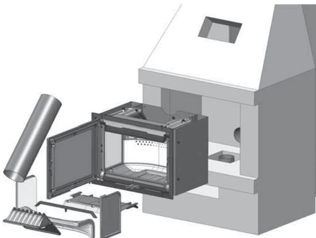
2. Ennen kuin tulipesä laitetaan tulisijaan, otetaan seuraavat osat pois: klapistoppari, sivupalolevyt, takapalolevy, tulipesän yläosa ja ohjauslevy. Osat laitetaan takaisin paikoilleen, kun savuputkin ja savunohjain on asennettu. Katso kuvia seuraavalla sivulla.
