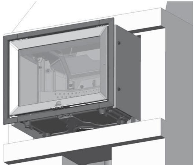
3. Työnnä tulipesä sisään alapuolen valetuilla jalaksilla, kunnes se on oikealla paikallaan. Säädä tulipesä suoraan kohdassa "Takkasydämen säätäminen suoraan" annettujen ohjeiden mukaan.
