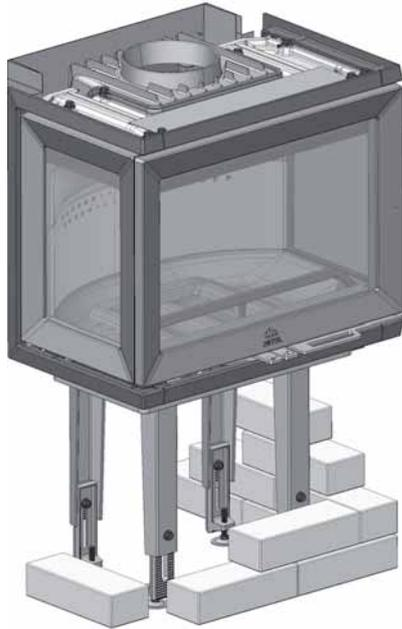
1. Cegły należy układać pod ramą wkładu.
