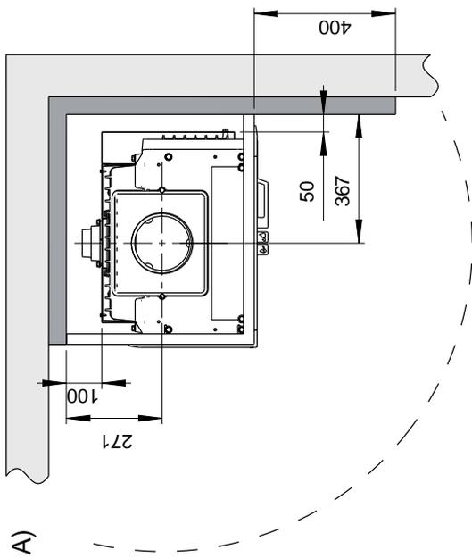
Minimalna odległość od ściany palnej chronionej murem ogniowym
