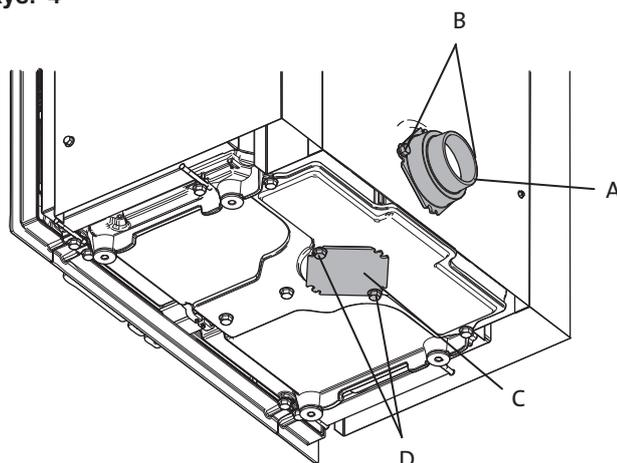
2. Odkręcić dwa wkręty (**B**) i zdemontować przyłącze wlotu powietrza (**A**).
