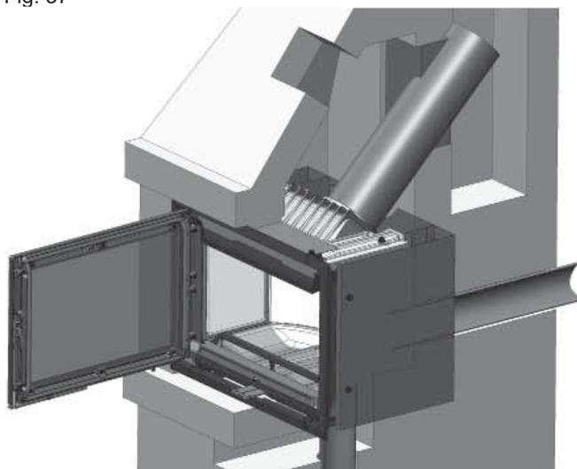
8. W przypadku instalacji przedstawionej w przykładzie 3, zalecamy wsunięcie rury podłączeniowej przez otwór drzwiowy komory spalania. Wsunąć rurę podłączeniową z założonym wylotem spalin przez otwór drzwiowy oraz otwór na wylot spalin i ewentualny materiał izolacyjny do komina.
