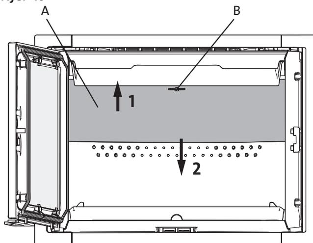
6. Najpierw unieść płytę dopalającą (**A**). Przekręcić klucz (**B**) o 90° i wyjąć. Pociągnąć tylną krawędź płyty dopalającej w dół.
