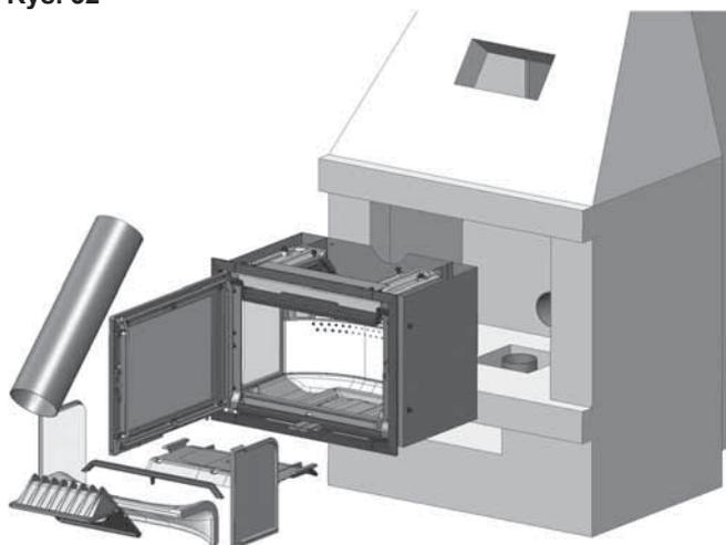
2. Przed umieszczeniem komory spalania w palenisku należy wyjąć ogranicznik polan, płyty boczne, płytę tylną, płytę dopalającą i deflektor spalin. Umieszcza się je ponownie po zainstalowaniu rury połączeniowej i wylotu spalin. Patrz rysunki poniżej
