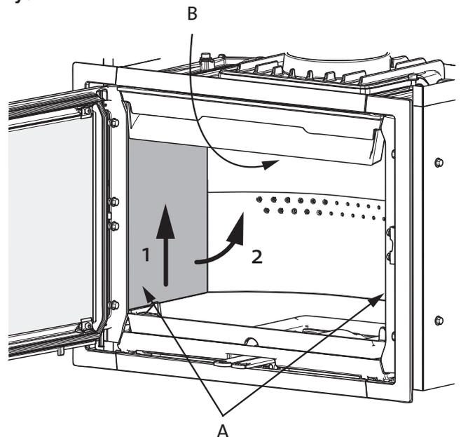
2. Wyjąć boczną płytę wewnętrzną (A), unosząc ją nieco i przytrzymując płytę dopalającą (B) w górze. Pociągnąć płytę boczną dołem i wyjąć. Następnie w ten sam sposób wyjąć drugą boczną płytę wewnętrzną.
