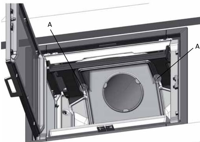
7. Następnie przymocować wylot spalin używając wkrętów (A), które zostały wykręcone podczas jego demontażu z położenia górnego.
