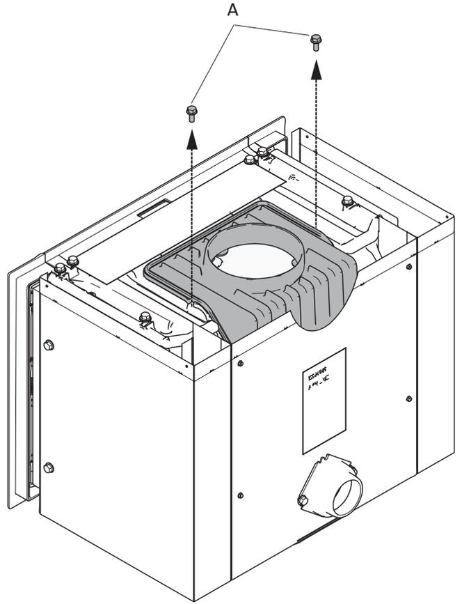
3. Irrota kaksi ruuvia (A), joilla savunohjain on kiinnitetty tulipesään.
