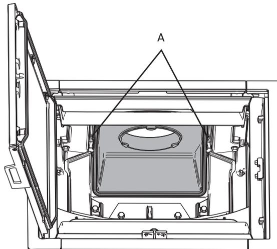
9. Kiinnitä tulipesän sisäpuolelta samat ruuvit (A), jotka irrotit ulkopuolelta.
