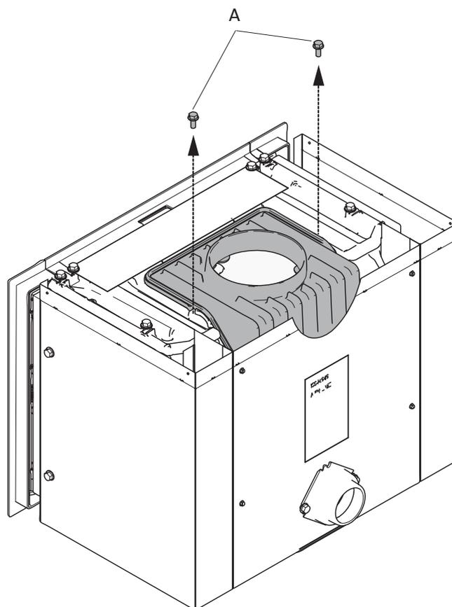
3. Wykręcić dwa wkręty (A), które mocują wylot spalin do komory spalania.
