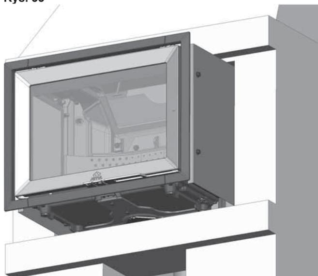
3. Wsuwać komorę spalania na wyprofilowanych prowadnicach na spodzie, aż znajdzie się na miejscu. Wypoziomować komorę spalania zgodnie z opisem w punkcie „Poziomowanie wkładu”.
