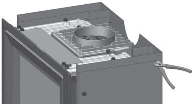
1. Przeciąć wzdłuż wybijanych otworów przy górnej części osłony termicznej i usunąć ten element.
