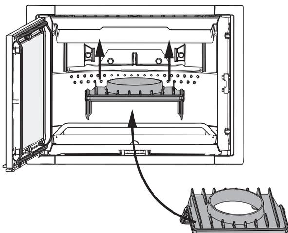
8. Zamocować wylot spalin od wewnątrz
