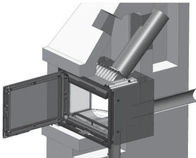
8. Kun teet asennuksen esimerkin 3 mukaisesti, on suositeltavaa, että työntät savuputken tulipesään luukun läpi. Laita savuputki, jossa on savunohjain paikallaan, luukun ja savunohjaimen aukon ja mahdollisen eristemateriaalin läpi savupiipun sisään.
