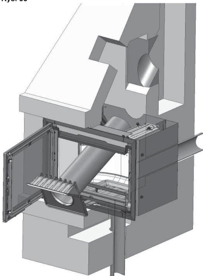
5. Przymocować wylot spalin (A) do końca rury podłączeniowej, gdzie została założona uszczelka.
